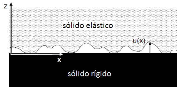
Figura 30 Contato mecânico elástico entre dois sólidos – perfil de separação u(x)
